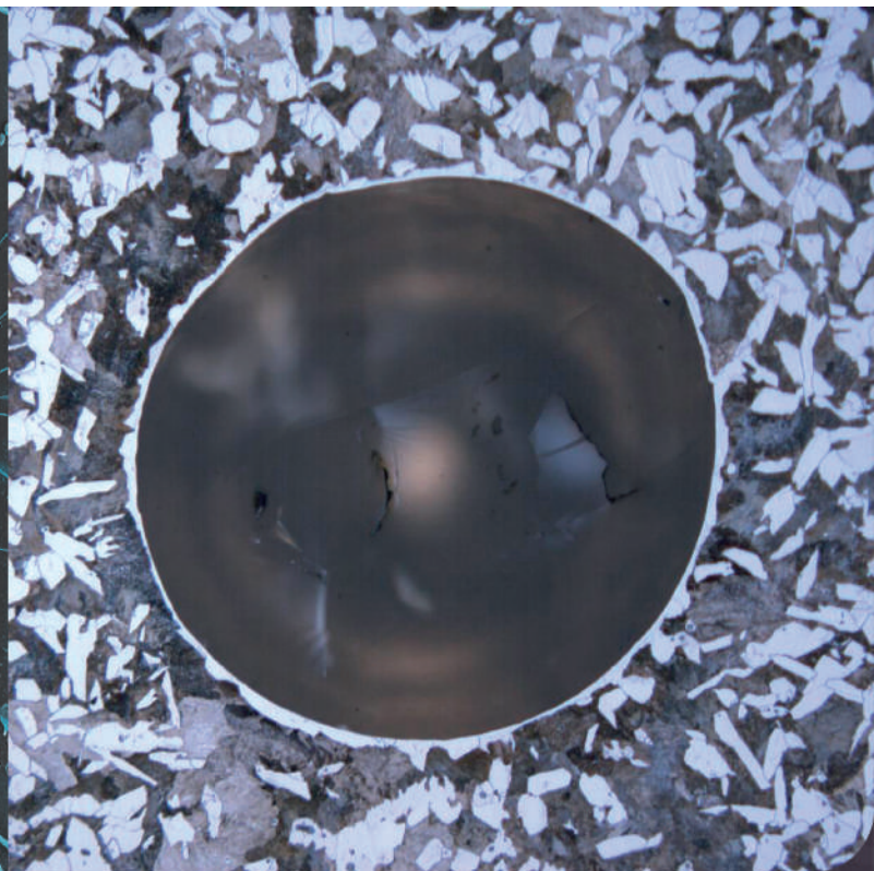
Inclusão em estrutura bruta de fusão de um aço SAE1026 microaligado com vanádio. Sandro Gonçalves Silva. UFRJ
