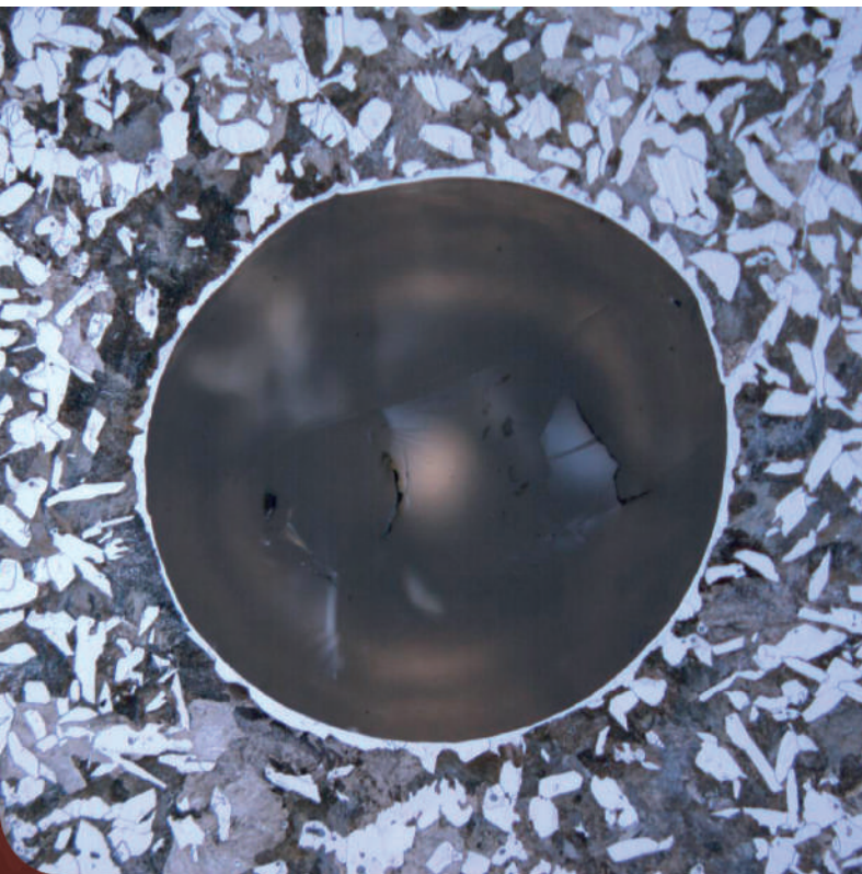
Inclusão em estrutura bruta de fusão de um aço SAE1026 microligado com vanádio. Sandro Gonçalves Silva. UFRJ
